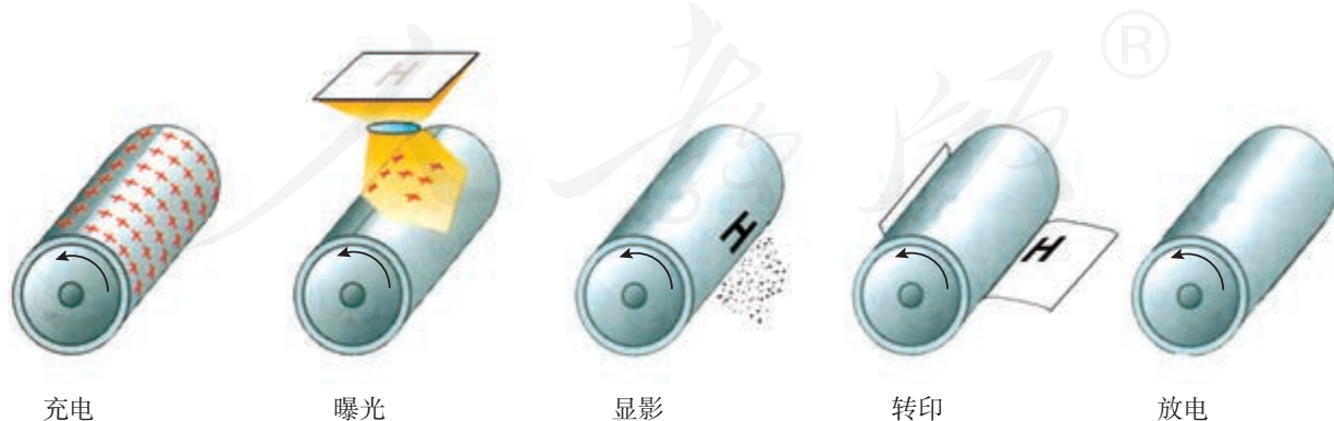
图9.4-9 静电复印的工作流程
