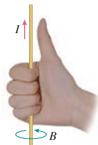
图 13.1-7 直线电流的安培定则
